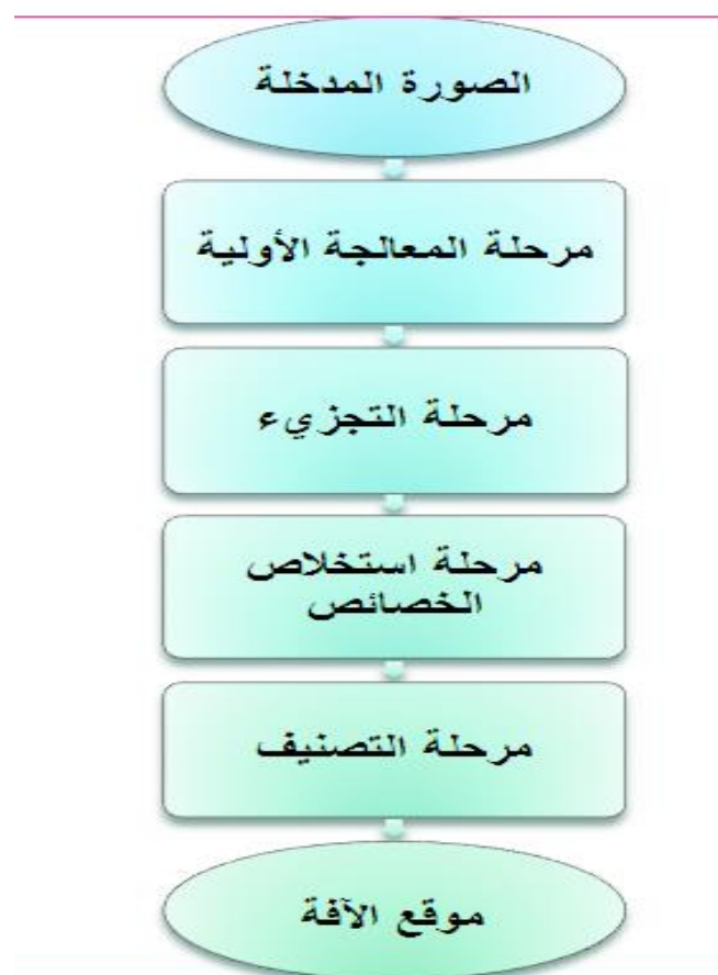
الشكل (4-1): المخطط العام لخوارزمية الكشف بمساعدة الحاسب CAD
