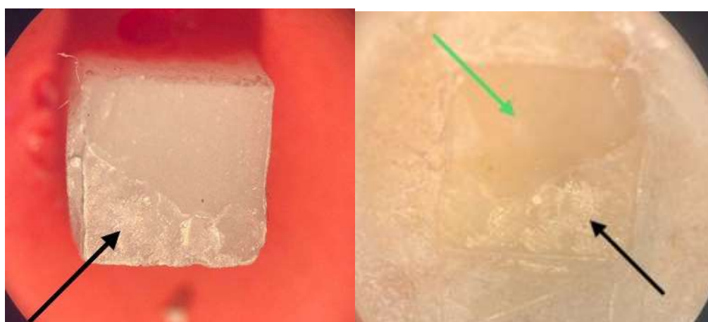
شكل 41 فشل مختلط لإحدى عينات Resin Cement
