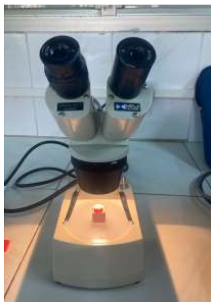
شكل 22 المكورة الضوئية Stereomicroscope المستخدمة في تحديد نمط الفشل
