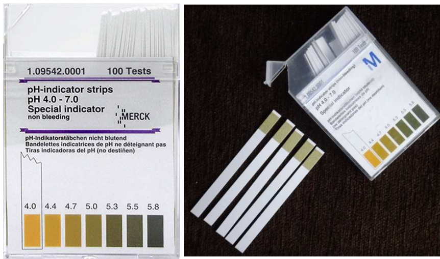
شكل 5 _ شرائط قياس ال pH (Spezialindikator, Merck) (Darmstadt, Germany) مع الدليل اللوني المرفق مع العلبة
