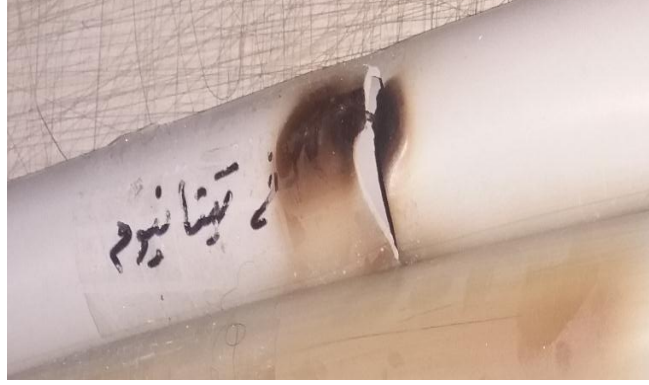
الشكل (5-6): أحد العينات المتشققة نتيجة اختبار الضغط الداخلي.
