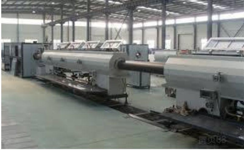
الشكل (2-8): قسم تبريد الأنابيب عن طريق الغمر بالمياه.
