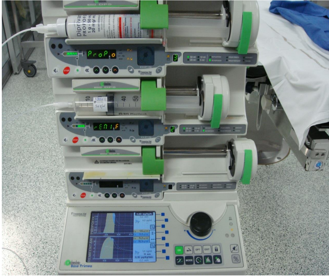
الشكل (2,5,3) جهاز التسريب TCI
