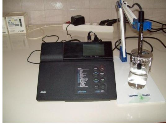
الصورة ٨. جهاز قياس درجة الحموضة الصورة ٩. جهاز قياس الضغط الحلولي
