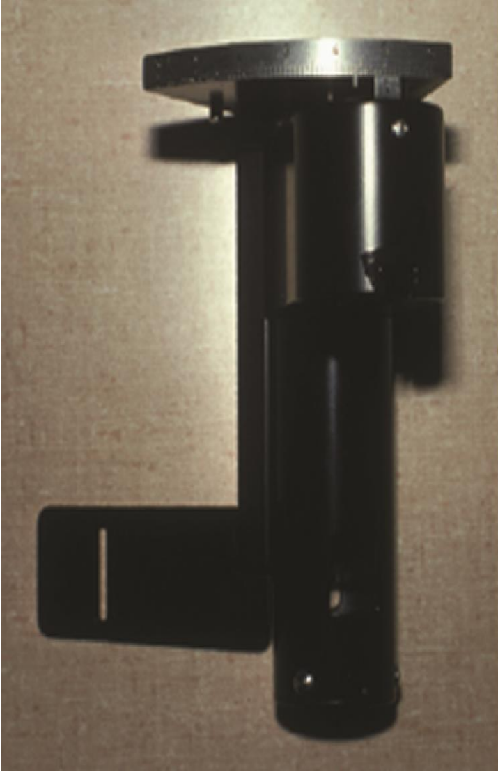
الشكل (23) جهاز Optical Pachymetry (132)
