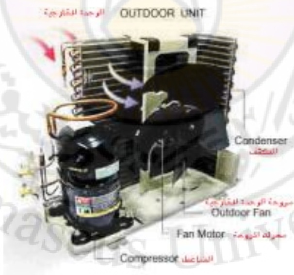
شكل (5-10) المكونات الأساسية للوحدة الخارجية
