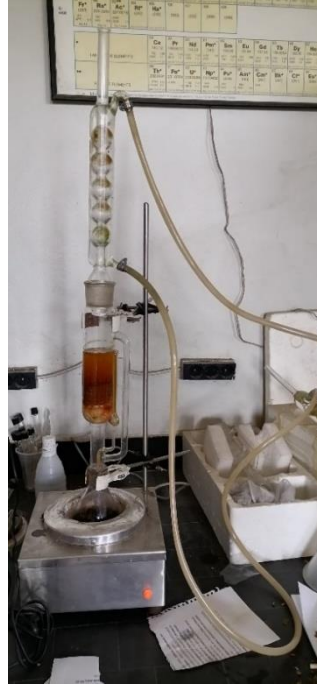
الشكل (21) تحضير المستخلص الكحولي باستخدام جهاز السوكسلت (Soxhlet) (الحوسه، 2022).
