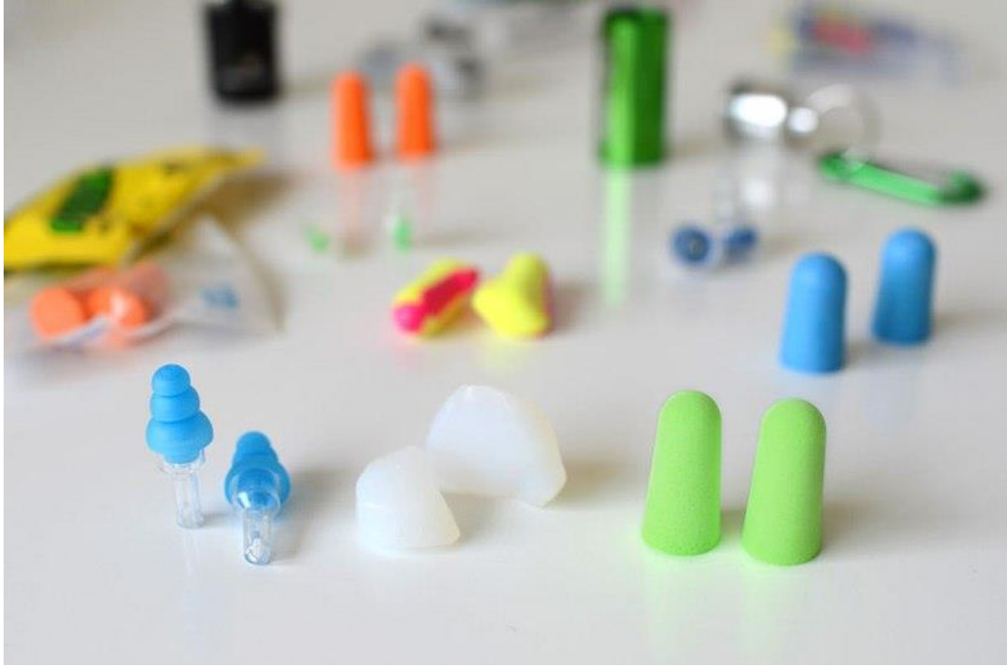
الشكل (3-11): أشكال متنوعة لجهاز حماية السمع نمط earplugs على اليسار pre-molded وفي الوسط formable وعلى اليمين roll-down. [35]
